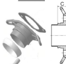
Sur la version 2, la cote "C" doit être au minimum de 15.5 mm.
