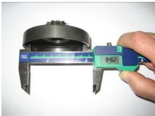
Le diamètre intérieur doit être mesuré avec un pied à coulisse. La mesure doit être faite au milieu de la cloche d'embrayage (sur la surface de frottement de la cloche).
