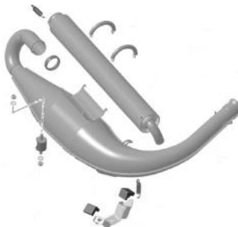
21.6.1 Sur la version avec silencieux démontable, seule la sortie coudée à 90° est autorisée. Cette sortie ne doit pas être orientée vers un composant du châssis.
