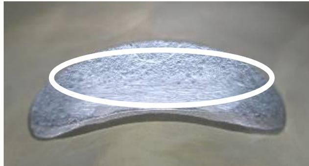
La lumière d'échappement peut présenter quelques traces de meulage manuel faites par le fabriquant afin d'éliminer les légers défauts de moulage et d'éliminer les bavures de NIKASIL situées à la fin de la surface traitée au NIKASIL
