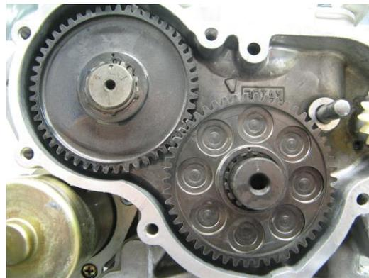
13.2 Les deux modèles de pignons de balancier aciers d'épaisseurs 6mm (mini 5.8mm) et 9 mm (mini 8.8mm) sont autorisés.
