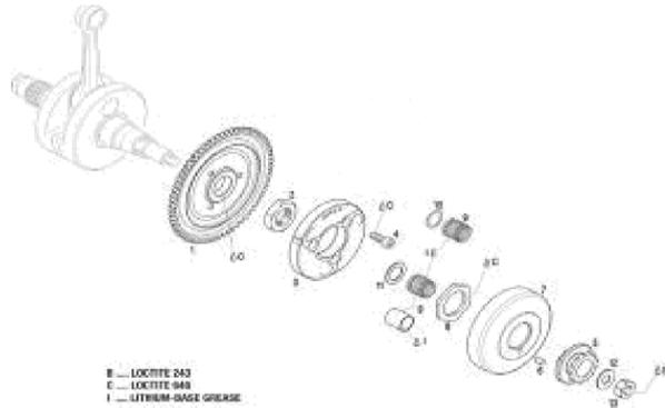
Les moteurs doivent être montés avec la nouvelle cage à aiguille (repère 9) et du joint de cloche d'embrayage (repère 10).
