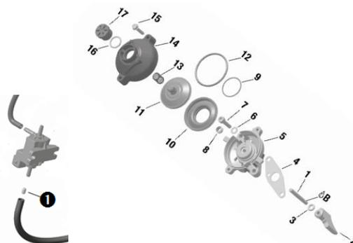
Un calibre (❶) dans la durite de pression, située entre l'électrovanne et la vanne (verte), peut être en place ou supprimé.
