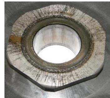
Les photos montrent le maximum de dépôt de graisse pouvant être centrifugé dans la cloche même avec le joint de cloche d'embrayage monté.
