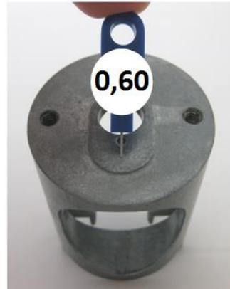
Une jauge de contrôle de 1.30mm ne doit pas entrer dans le trou vertical.
