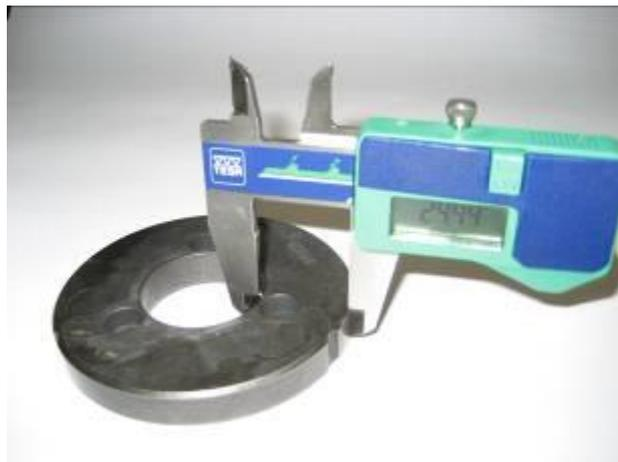
La mesure doit être faite sur les 3 patins d'embrayage, 5 à 10 mm de l'extrémité de chaque patin.
