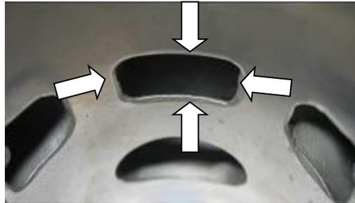
Le bord supérieur et inférieur du transfert avant peut présenter quelques traces d'usinage.
