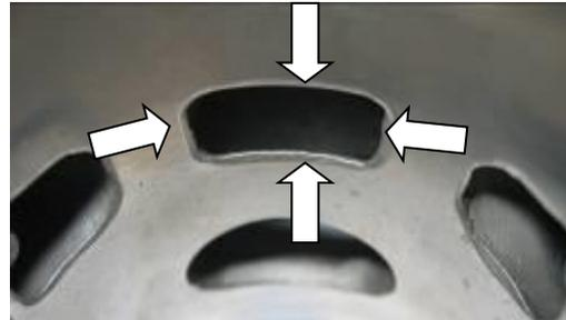
Sur le cylindre 613933, le bord supérieur et inférieur du transfert avant peut présenter quelques traces d'usinage.
