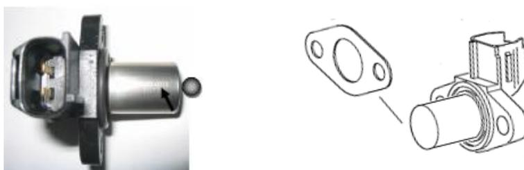
Monter le joint (Rotax PMFR362.104) entre le capteur d'allumage et le joint caoutchouc est autorisé. Un maximum de 2 joints est autorisé (en plus du joint caoutchouc).
