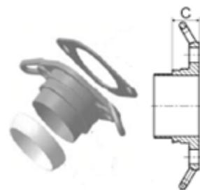
Sur la version 2, la cote "C" doit être d'au moins 15.5 mm.
