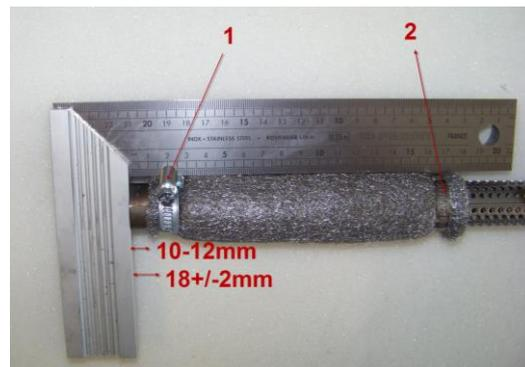
Le collier N°1 doit être fixé à une distance de 18mm +/-2mm (mesure depuis l'extrémité du tube).
