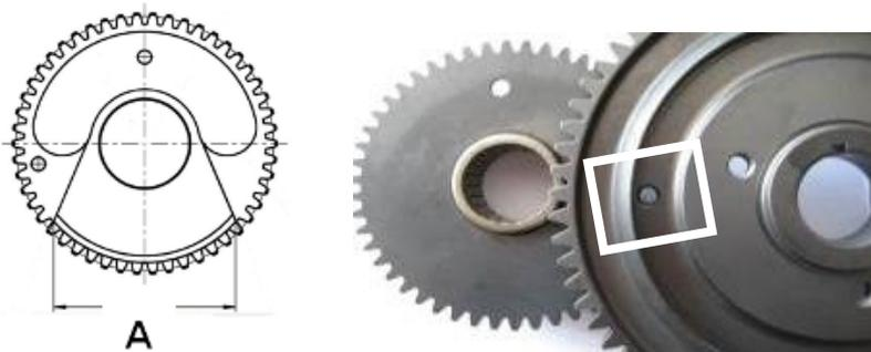
Sur la version 2, la cote A (partie la plus large du poids du balancier) doit être de 53mm (tolérance+/- 0,5) ou de 57mm (tolérance+/- 0,5).
