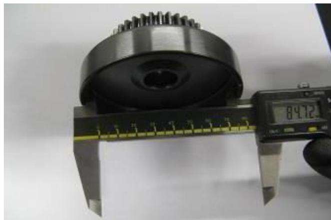
Le diamètre intérieur doit être mesuré avec un pied à coulisse. La mesure doit être faite au milieu de la cloche d'embrayage (sur la surface de frottement de la cloche).
