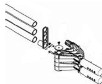
En cas d'utilisation du pare-chocs arrière Rotax, la version 2 tubes ou la version 3 tubes peut être utilisée. Le 3<sup>ème</sup> tube pourra être monté dessus ou en dessous des deux tubes principaux.
