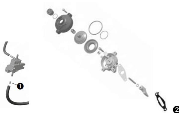
Un calibre (❶) dans la durite de pression, située entre l'électrovanne et la vanne (verte), peut être en place ou supprimé.
