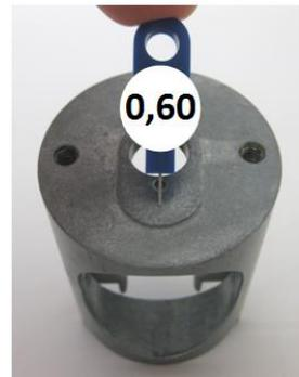
13.29 Une jauge de contrôle de 1.30mm ne doit pas entrer dans le trou vertical.
