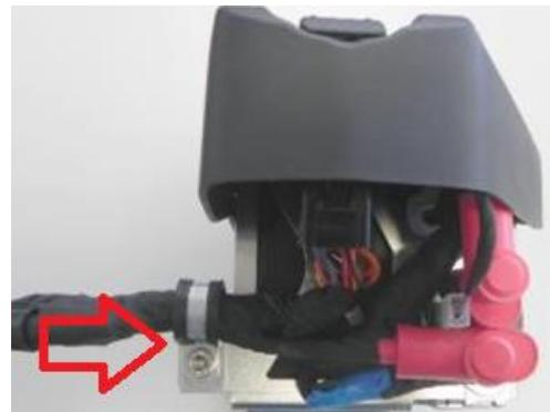
12.26 Optionnel : le faisceau électrique de dernière génération peut être recouvert d'isolant au niveau des prises de l'électrovanne et de la bobine d'allumage:
