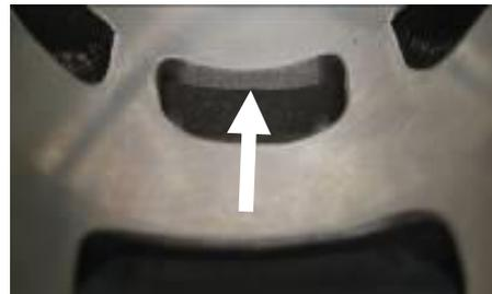
5.5.4 Le plan de joint de la sortie d'échappement à une finition moulée ou usinée. La surface peut être plate ou présenter un bossage.
