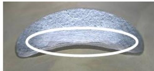
5.5.6 Le cylindre présente des rainures de fonderie dans la boîte à clapet (qui peut être repéré, ou non, d'une lettre dans la fonderie (par exemple "X"))
