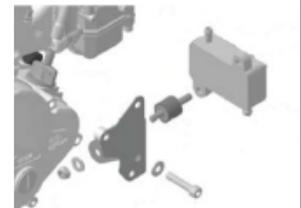
14.2 La pompe est fixée au moyen de 2 silent-blocs .Le montage de la pompe à essence sur le châssis est une option permise. Dans ce cas, la pompe à essence doit être montée sous l'axe du carburateur.
