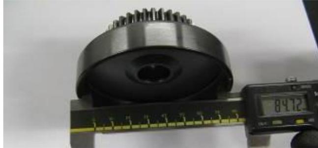
Le diamètre intérieur doit être mesuré avec un pied à coulisse. La mesure doit être faite au milieu de la cloche d'embrayage (sur la surface de frottement de la cloche).
