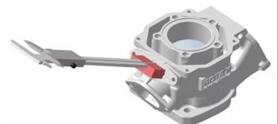
Mesurez la distance entre l'extrémité du gabarit et la surface du cylindre.
