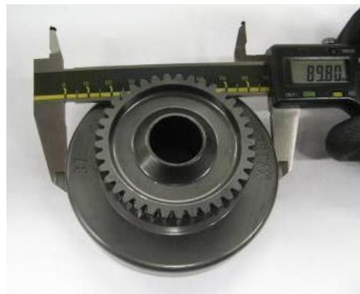
Le diamètre doit être mesuré avec un pied à coulisse positionné en appui sur la cloche (et non à la verticale de la cloche).
