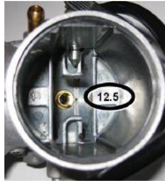
13.28 Une jauge de contrôle de 0,60mm ne doit pas entrer dans le trou oblique.
