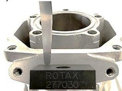
La mesure doit être effectuée en dehors de la zone de contact de la valve d'échappement (indiquée en rouge ci-dessous).
